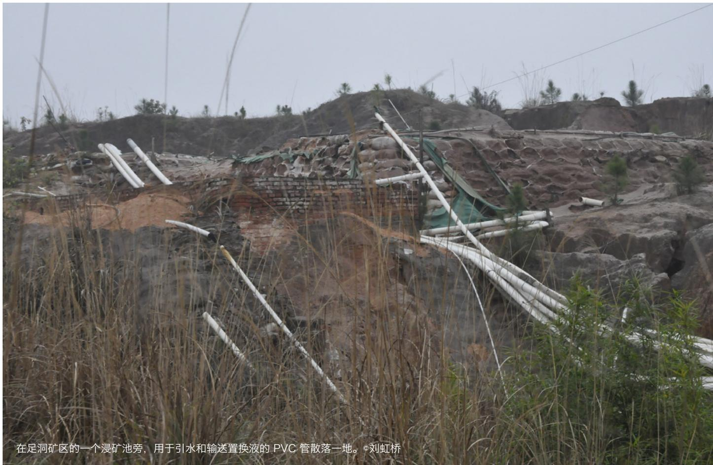
在足洞矿区的一个浸矿池旁，用于引水和输送置换液的 PVC 管散落一地。©刘虹桥
